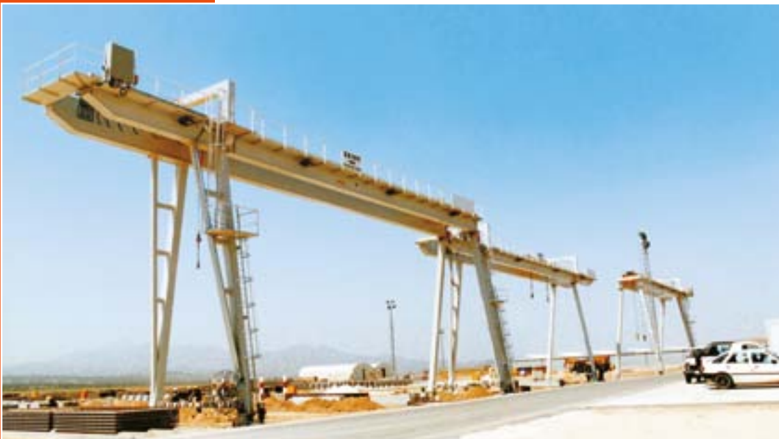
Gantry cranes 2 x 10t (Hochtief)
